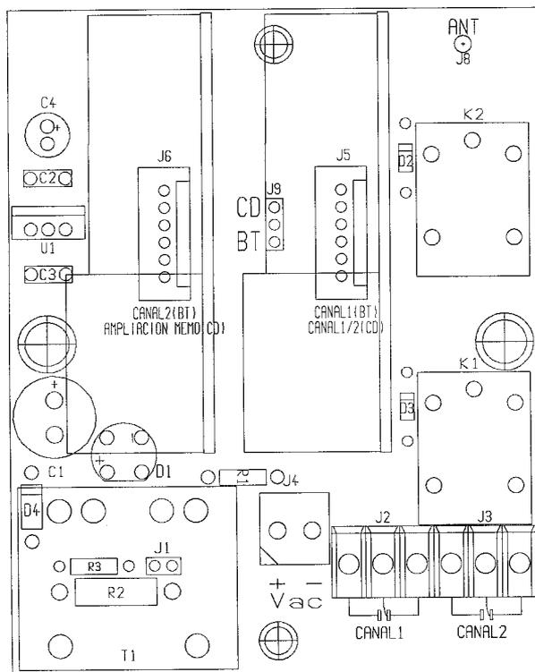
La RXBASE es una base para la conexión de Receptores Enchufables con conectores de 6 Pin de los modelos Binario, Trinario y Código Dinámico permitiendo a estos que funcionen como Receptores independientes Monocanales ó Bicanales alimentados a 12 Vdc ó 24 Vdc.
